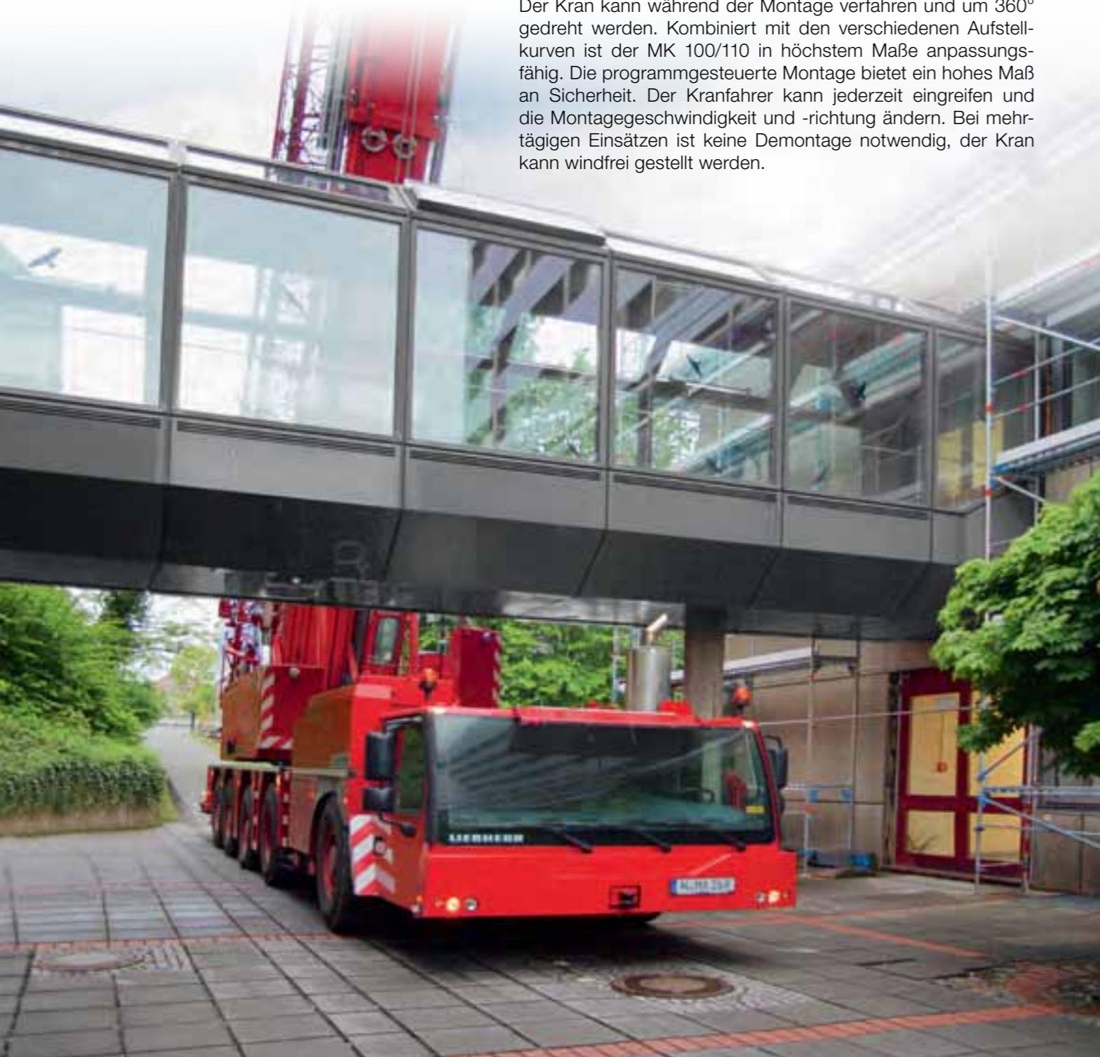
Der Kran kann während der Montage verfahren und um 360° gedreht werden. Kombiniert mit den verschiedenen Aufstellkurven ist der MK 100/110 in höchstem Maße anpassungsfähig. Die programmgesteuerte Montage bietet ein hohes Maß an Sicherheit. Der Kranfahrer kann jederzeit eingreifen und die Montagegeschwindigkeit und -richtung ändern. Bei mehrtagigen Einsätzen ist keine Demontage notwendig, der Kran kann windfrei gestellt werden.
